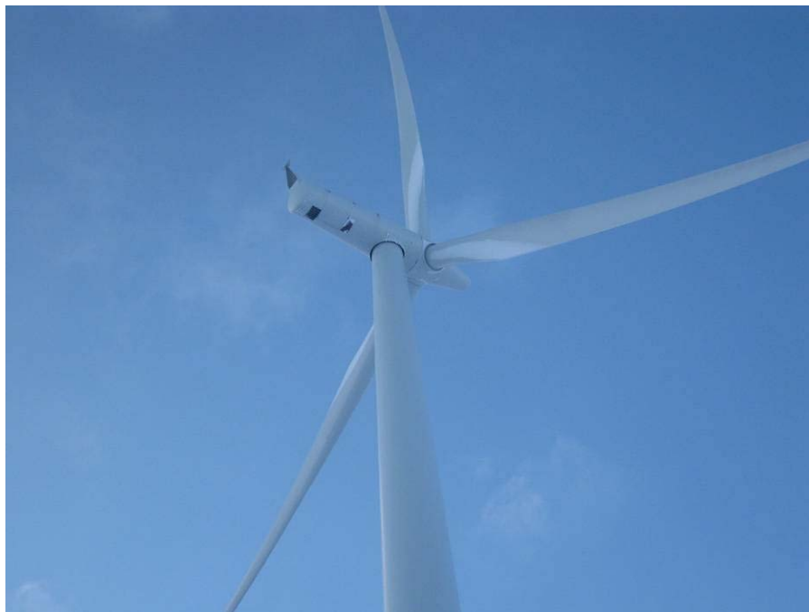
Figur 6 Episode fra Kjøllefjord 29.mars 2008. Det er også isdannelse på fremkanten (den runde) av vingen.
